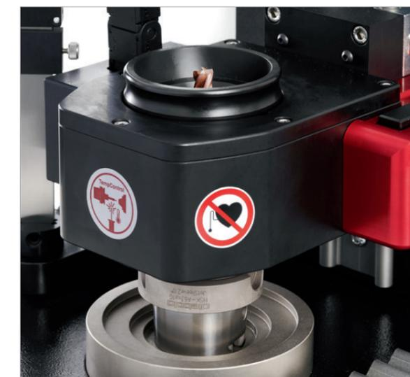
Mit den vertikalen Geräten der US 1100 Serie können Schrumpfaufnahmen von Ø 3 – 32 mm (HM) und Ø 6 – 32 (HSS) mit fest hinterlegten Parametern geschrumpft werden.
