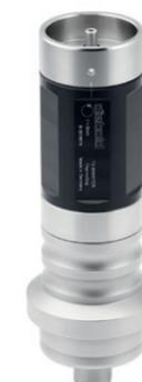
Adapter zur Aufnahme von Einsätzen für TER Spannangen im vertikalen Schrumpfgerät. Sicheres und einfaches Einstellen der Auskarglänge ihres Fräasers während dem Schrumpfvorgang für Schrumpfzangen. Der Adapter ist einstellbar. Durch Drehen des Schaftes wird der eingesetzte PIN verstellt und dient als Anschlag für die Längeneinstellung eines Schneidwerkzeugs in der TER Zange während des Schrumpfens.
