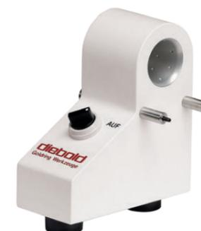
Der Luftkühler wird an das MS 502-P angedockt. Nach dem Erwärmen des Schrumpffutters wird die Werkzeugaufnahme um 180° gedreht, das Futter in den Kühler geschoben und anschließend das Ventil geöffnet. Durch seine patentierte Luftstromführung werden Schrumpffutter schnell und effektiv gekühlt. Nach 1–3 Minuten, je nach Futterkontur, ist die Außenkontur abgekühlt.
