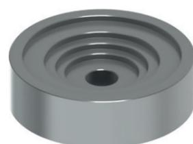
Die Zentrierscheibe dient als Werkzeugaufnahme im Schrumpfgerät US1100 vertikal und im Flüssigkeitskühler FKS 04 S. HSK Aufnahmen HSK100, HSK80, HSK63 passen in die entsprechende Ringöffnung. Für kleine HSK Aufnahmen und SK/BT Aufnahmen stehen die Werkzeugadapter siehe Seite 33 zu Verfügung, die in die Zentrierscheibe eingesetzt werden.
